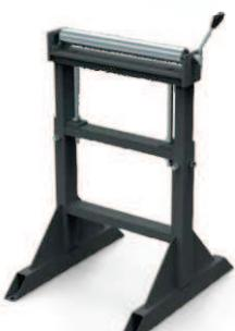
**KRT** Výškově nastavitelná noha s excentrickým válečkem. Je ideální ekonomickou variantou podpory materiálu při řezání. Excentricky uložený silnostěnný váleček umožňuje manuální přizvednutí materiálu nad ložnou plochu stroje a tím jeho snadnější posunutí. Váleček je výškově stavitelný v rozsahu 760 mm až 960 mm.
